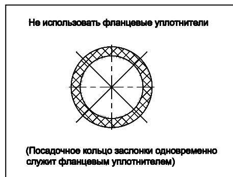
«Ширина в свету» контрафланца – включая внутреннее покрытие – должна иметь достаточный размер, чтобы пластина заслонки могла полностью открываться без соприкосновения ( $\varnothing D_i \geq \varnothing L + 6 \text{ мм}$ ). Этот размер необходимо проверить перед установкой заслонки и сопоставить с пространственной потребностью заслонки согласно данным таблицы.
