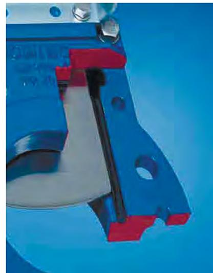
Благодаря боковым поверхностям пластины и эластичному седельному уплотнению корпуса проход герметичен **в обоих направлениях** потока. Боковые направляющие пластины обеспечивают передвижение ножа шибера без вибраций и колебаний, а также дроссельное положение.
