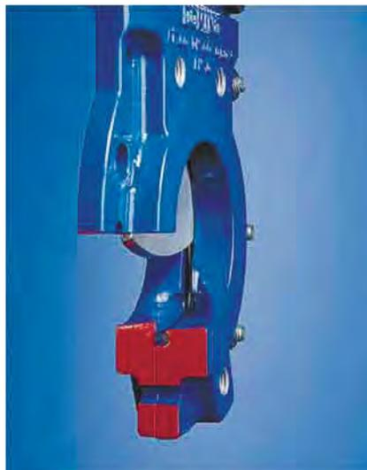
**Эффект самоочистки** достигается благодаря специальным зонам промывки в корпусе и режущей кромке пластины шибера. Твердые частицы среды и волокна разделяются режущей кромкой до того, как пластина достигнет эластичного уплотнения. Направляющая пластины прерывается по длине хода, таким образом, загрязнения могут выталкиваться.
